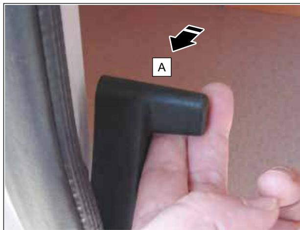
Abb. 15 Zweiten Flügel der Zweiflügel-Hecktür öffnen und schließen
