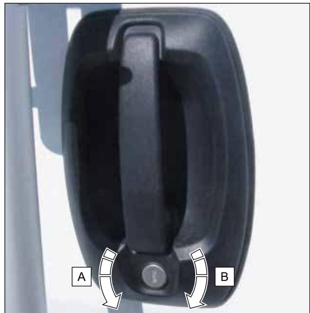
Abb. 13 Ersten Flügel der Zweiflügel-Hecktür von außen öffnen und schließen
