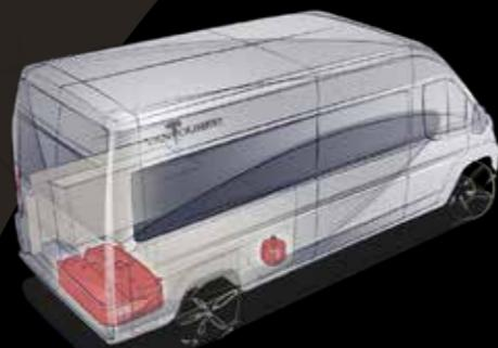
Ma il VANTourer ha la soluzione: il serbatoio dell'acqua potabile ora è sotto il veicolo. Grazie al compatto riscaldamento centrale TRUMA diesel, invece delle bombole da 11 kg ora vi è una sola bombola da 3 kg che è utilizzata esclusivamente per cucinare.
