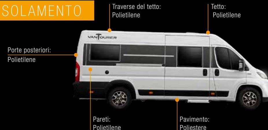
Ben temprato in tour: l'isolamento ottimizzato per i ponti freddi garantisce un clima perfetto, ovunque vi troviate. I fianchi traspiranti e rivestiti in tessuto, i materiali utilizzati nella zona del soffitto e del pavimento permettono di avere i più alti valori di isolamento e il massimo assorbimento di umidità. Tutto rimane asciutto, a differenza di molti altri veicoli dove le pareti laterali sono fatte di plastica.
