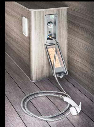
... e l'interno del veicolo pulito. La scatola di collegamento apribile si trova a portata di mano nella parte posteriore destra del vano posteriore. Il flessibile doccia con soffione può essere montato in modo semplice e veloce.
