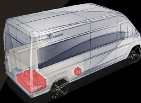
Ma il VANTourer ha la soluzione: il serbatoio dell'acqua fresca si trova ora sotto il veicolo. Grazie al riscaldamento centralizzato compatto Truma, invece della bombola da 11 kg ora è sufficiente una piccola bombola di gas (Campingaz tipo R 907 da 2,75 kg), necessaria solo per cucinare.
