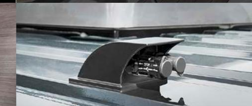
12 Collegamento solare grazie al precablaggio del tetto
