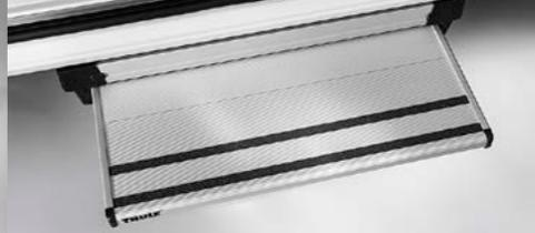
7 Einstiegsstufe mit elektrischer Ausfahrfunktion
