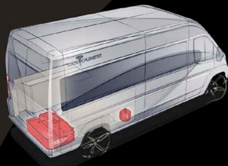
Doch der VANTourer hat dafür die Lösung: Der Frischwassertank befindet sich nun unter dem Fahrzeug. Dank der kompakten Truma Zentralheizung fährt nun statt der 11-kg- nur noch eine kleine Gasflasche (Campinggaz Typ R 907 2,75 kg) mit, die nur noch zum Kochen benötigt wird.
