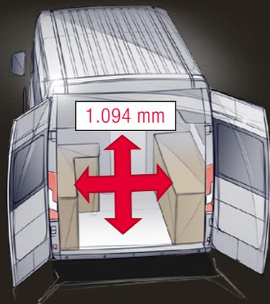
Die großen seitlichen Heckstaukästen ragten weit in den Ladebereich hinein, wodurch wenig Platz zum Beladen zur Verfügung stand. Platzverschwendung!
