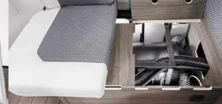
4 Dieselheizung unter der Sitzbank integriert
