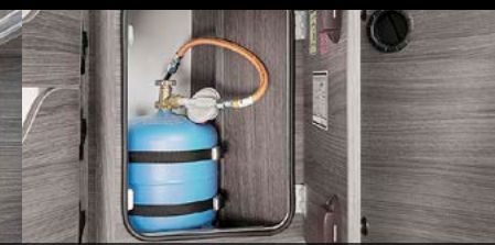
13 Compartimento para gas (Campingaz R 907 2,75 kg)
