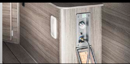
16 Conexión para ducha exterior, incluida manguera
