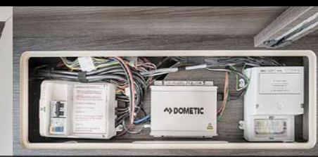
14 Electrónica de a bordo moderna (parte trasera)
