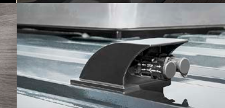
12 Raccordement solaire grâce au précâblage du toit
