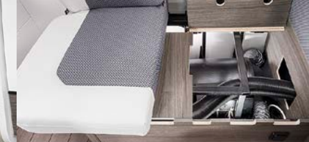
4 Chauffage au diesel sous la banquette
