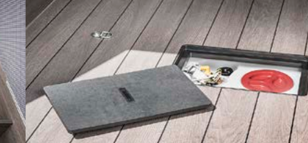
5 Ouverture de nettoyage du réservoir d'eau fraîche
