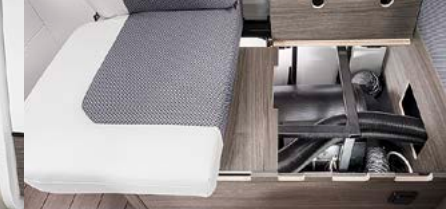
4 Riscaldamento a diesel (sotto la zona salotto)
