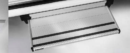
7 Scalino d'accesso a movimento elettrico
