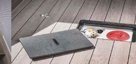
5 Apertura di pulizia serbatoio acqua pulita
