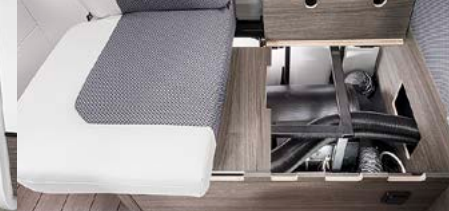
4 Dieselyverwarming onder de zitbank
