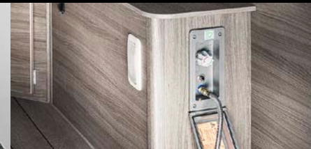
16 Przyłącze do prysznica zewnętrznego
