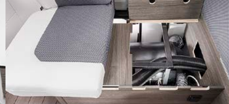
4 Dieselyrmare (inbyggd under bänken)
