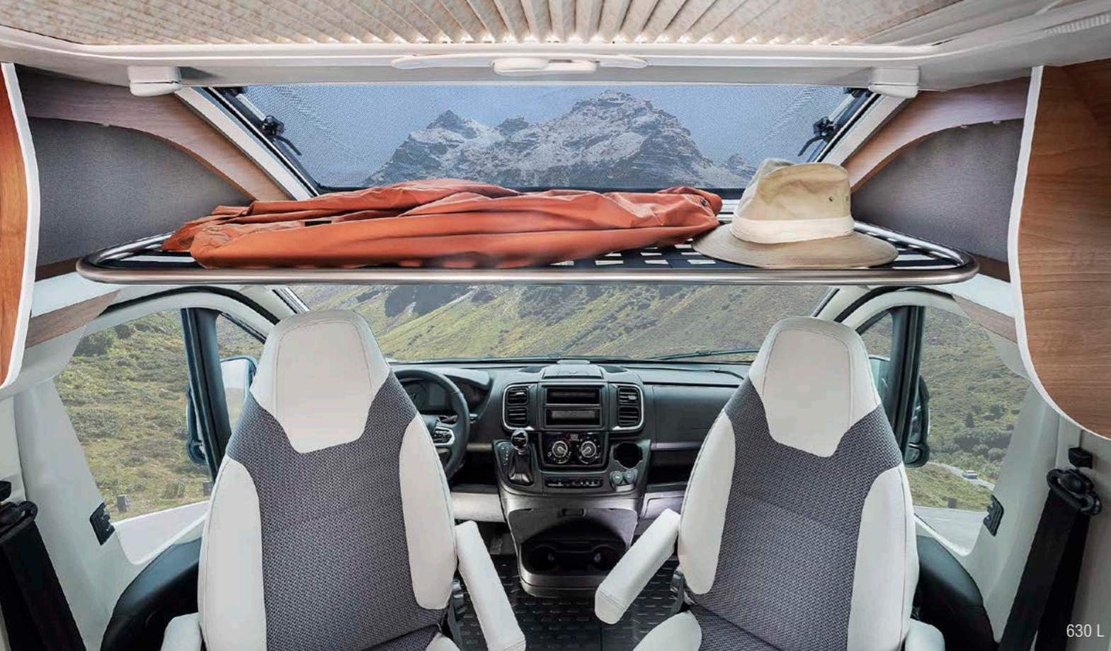
**Lass mehr Licht herein.** Der neue optionale Bugausbau mit großem Panoramafenster sorgt für einen besonders lichtdurchfluteten Wohnraum. Für ein optimales Raumklima lässt sich das Fenster nach außen ausstellen. Davor ist eine klappbare Ablage positioniert. Sie ist ideal zum Verstauen von Jacken und anderen leichten Kleidungsstücken. An den Seiten neben der Ablage finden Sie weiteren praktischen Stauraum.
