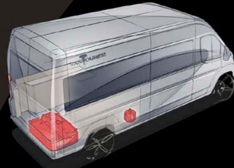
Doch der VANTourer hat dafür die Lösung: Der Frischwassertank befindet sich nun unter dem Fahrzeug. Dank der kompakten Truma Zentralheizung fährt nun statt der 11-kg- nur noch eine 3-kg-Gasflasche mit, die nur noch zum Kochen benötigt wird.
