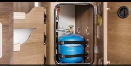
13 Gasflaschenfach für 3-kg-Gasflasche
