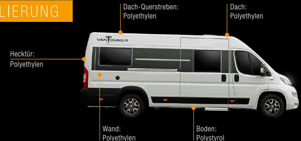
Wohltemperiert auf Tour: Die kältebrückenoptimierte Isolation garantiert perfektes Klima, wo immer Sie auch sind. Die atmungsaktiven, stoffbezogenen Seitenwände und die in der Decke und dem Bodenbereich eingesetzten Materialien überzeugen durch höchste Isolierungswerte und maximale Wasserabsorption. Alles bleibt trocken – im Gegensatz zu vielen Wettbewerbsfahrzeugen, bei denen die Seitenwände aus Plastik sind.
